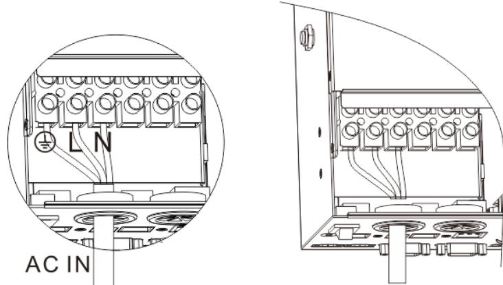
③根据下图所示线缆顺序和端子位置，正确接上交流输出线，请先接地线，再接火线和零线，地线通过O型端子接到机箱接地螺丝孔。
