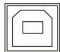
软件进行 USB 通信，使用此端口需要在电脑中安装对应的“USB 转串口芯片 CH340T 驱动程序”。
