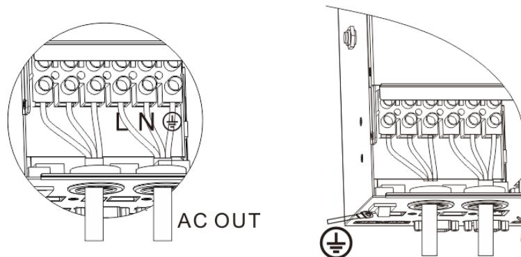
注意：接地线缆尽量用粗线径（导线截面积不小于 4mm<sup>2</sup>），接地点尽量靠近一体机，接地线越短越好。
